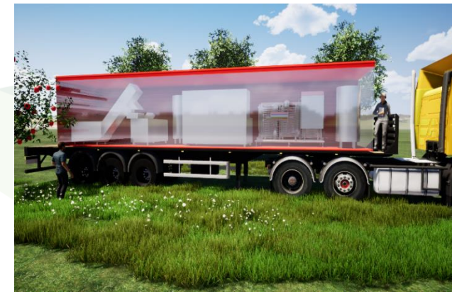
Modell einer mobile Einheit zur Fruchtsaftextraktion unter wenig Sauerstoff
