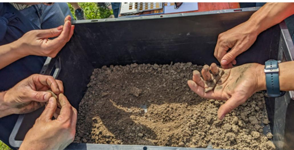
Lässt sich mit der Fingerprobe ein Ring formen oder nur eine bleistiftdicke Wurst? – Damit wird über Sand, Schluff- und Tonanteile entschieden.
