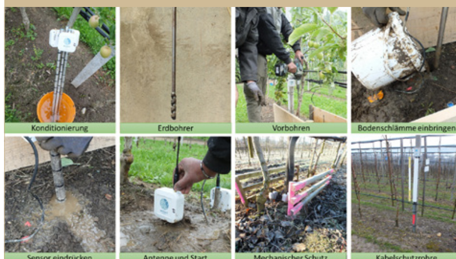
Abb. 2: Installationsanleitung eines Watermark-Sensors im Baumstreifen einer Obstanlage
