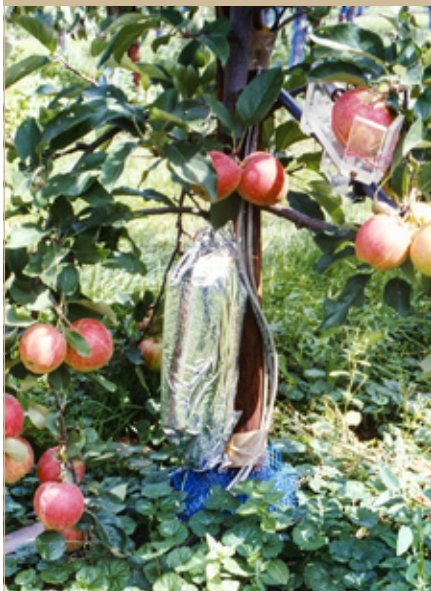
Abb. 1: Stammflussmessung an einem Apfelbaum mit entsprechendem Strahlungsschutz sowie Fruchtwachstumsmessung
