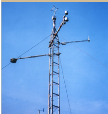
Abb. 2: Meteorologische Messstation in einer Apfelanlage zur Messung des Gesamtwasserverbrauchs
