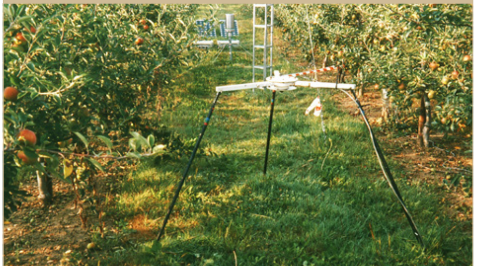
Abb. 3: Energiebilanzmessung (Bowen Ratio) in einer Apfelanlage zur Messung des Wasserverbrauchs des Grasstreifens
