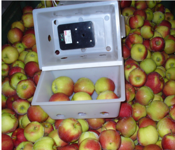
Abbildung 14: Chlorophyll-Fluoreszenz-Sensor für den Einsatz bei der DCA- Lagerung in einer Großkiste positioniert
