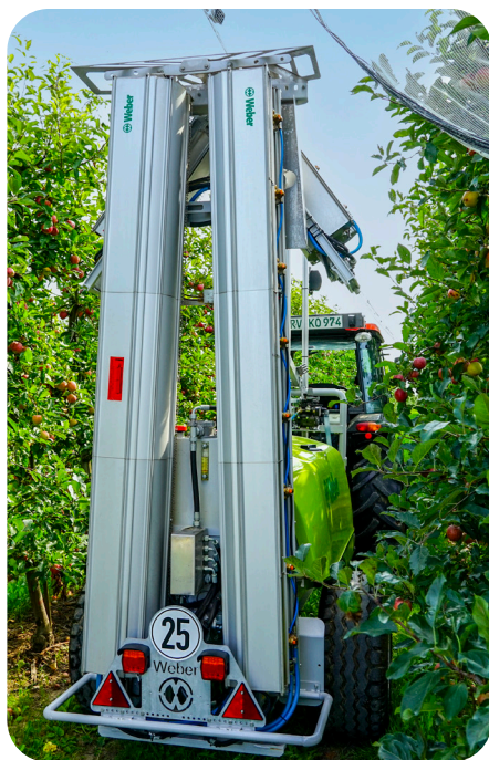
PFLANZENSCHUTZ-VERSUCHSGERÄT MIT ZWEI LIDAR-SENSOREN PRO SEITE BEIM TESTEINSATZ IN EINEM APFELBESTAND.
