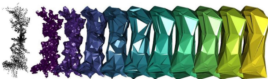
BERECHNUNG DES BAUMVOLUMENS in der Software R aus der aufgenommenen Punktwolke (links) mit der LiDAR-Sensorik. Je nach Eingabe der bestimmenden Parameter verändert sich das Baumvolumen (Zunahme nach rechts).
