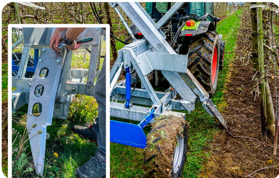
WURZELSCHNITT IM FRÜHJAHR: Ausschnitt zeigt ein von Fruit Tec neu entworfenes Schnittmesser.
